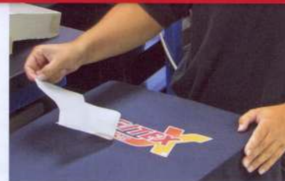
Na het persen kan de transferfolie van het T-shirt worden getrokken.
