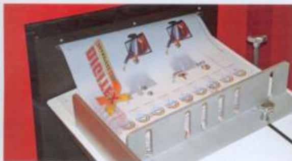
Op de Xeikon 5000 wordt de fullcolour afbeelding op de transparante folie geprint.
